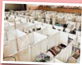
紙管による簡易間仕切りの例
